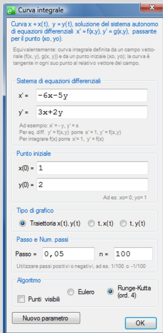
curva soluzione  $x(t)$ ,  $y(t)$  sarà tracciata per  $t$  che va da 0 a  $0,05 * 100 = 5$ . Dei due possibili algoritmi per la soluzione numerica del sistema, l'algoritmo di Eulero e l'algoritmo di Runge-Kutta, è selezionato per impostazione predefinita il più efficiente dei due cioè Runge-Kutta. Qui a fianco vedete la curva soluzione tracciata da EffeDiX. E' stato anche tracciato il punto iniziale (1, 2).
